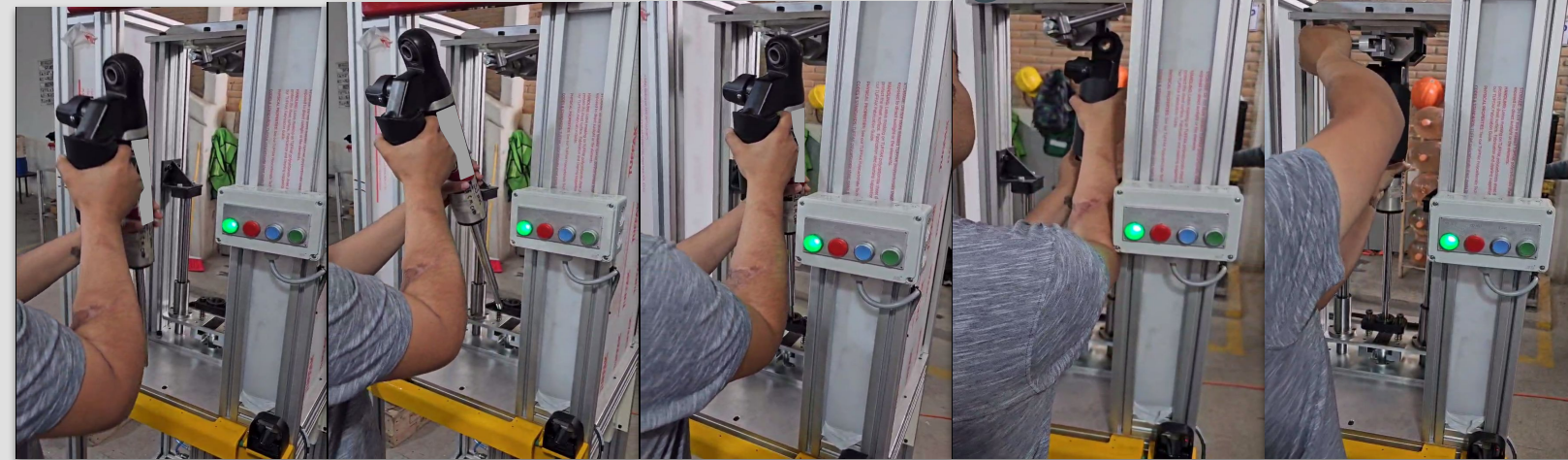
Colocación de amortiguador
