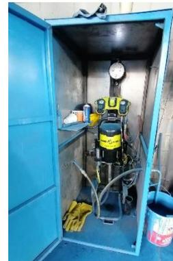
Máquina de Pintura Electroestática y Airless
